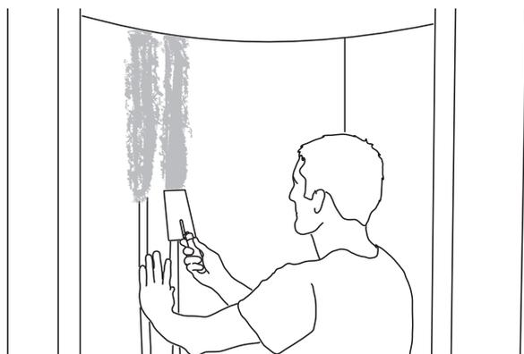
11) Alle Längsfugen der Wandelemente werden auf der Innenseite mit dem JACKOBOARD® Dichtband oder alternativ mit JACKOBOARD® Abdichtungsset (oder gleichwertig) abgedichtet. Die Stirnkanten im Eingangsbereich sowie die Längsfugen auf der Außenseite werden mit dem JACKOBOARD® Armierband abgespachtelt.
